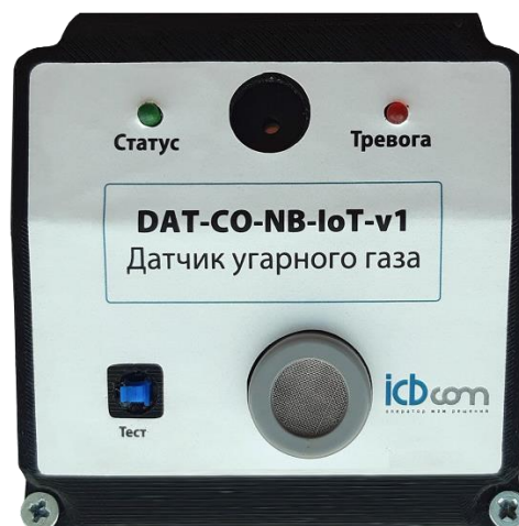
Рисунок 1 – DAT-CO-NB-IoT-v1 ” - Извещатель превышения концентрации угарного газа
